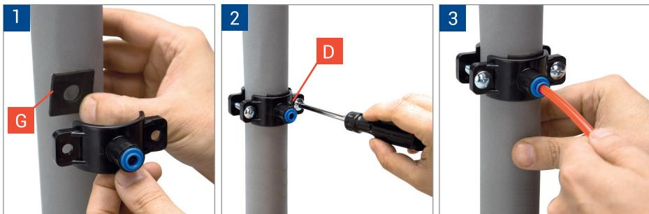
Pričvrstite držać (D) na cev za odvod pomoću vijaka istovremeno dotežući oba vijka pazeći na rupu za odvod (Slika 2).Vijci moraju biti ravnomerno zategnuti kako bi obe stege bile paralelne.
